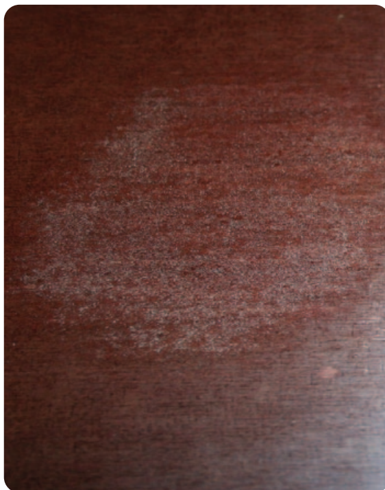
Прогар от дефекта внутреннего слоя (закор серединный)
